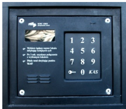
Fotografia 4.1. Domofon z panelem dotykowym. Pomimo zastosowania napisów w alfabecie Braille'a domofon jest niedostępny dla osób niewidomych.
